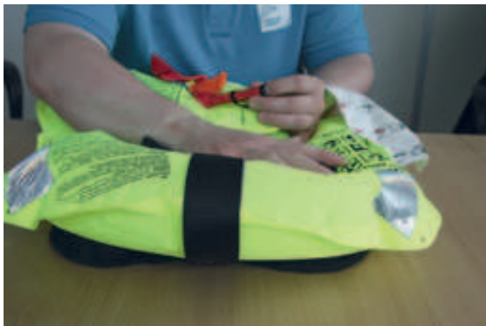
Tyhjennä liivi puristamalla täyttöputken päässä olevaa venttiiliä
