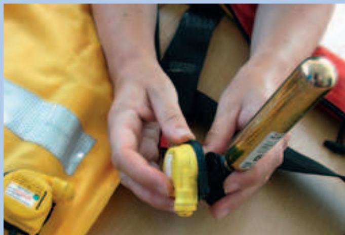
Hammar-yksiköt ovat suljettuja ja pullo on liivin ilmasäiliön sisällä.
