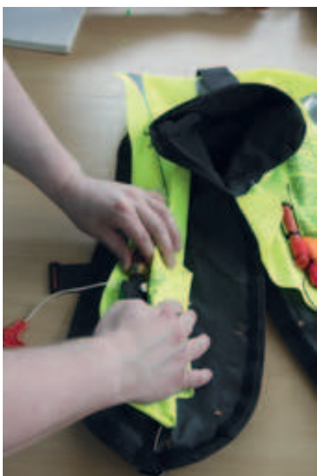
1. Aloita ilmasäiliön taittaminen liivin laukaisulaitteen puolelta.
