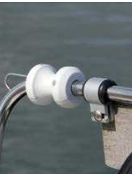
Keula- tai peräkaiteeseen kiinnitetty pyörivä rulla on pieni, mutta kätevä apu ankkuria nostettaessa.
