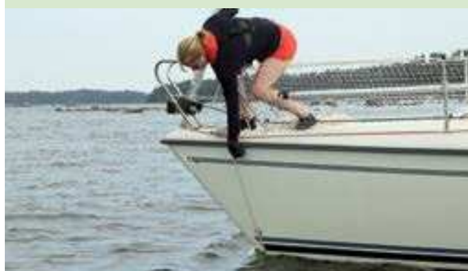
Jos ankkuri ei heti irttoa, sidotaan köysi kireälle ja odotetaan hetki. Jos tämäkään ei auta, ajetaan varovaisesti ankkurin yli keulagasti tunnustele köydestä milloin ankkuri irttoa.
