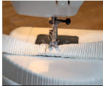
39 Sitten ompelukone laulamaan. Käytävä naiton- tai polyesterialankaa, sen on oltava vahvaa. Ensin 1 275-, sitten 1295-kohdasta.
