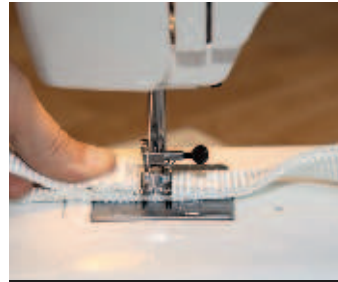
40 Silmukan saat taittamalla liinaa taaksepäin. Merkinät 750 millimetriä ja 120 millimetriä tulevat kohdakkain. Ompele kiinni.
