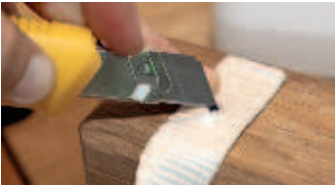
42 Leikkaa reiät painoneppareita varten 30 mm ja 105 mm:n kohdille.
