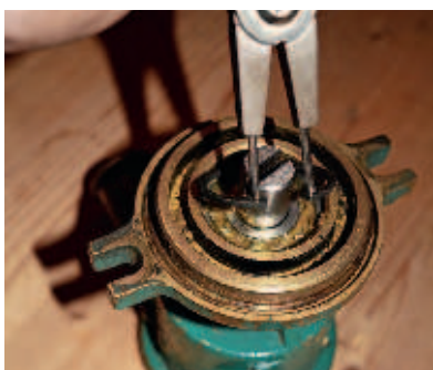
6 Irrota akselia ja laakeria paikallaan pitävä lukkorengas. Ellet omista lukkorengaspihtejä, kokeile poistaa se kärkipihdeillä.
