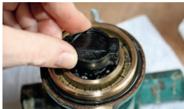
5 Akselin päässä, joka menee moottorin sisään, saattaa olla holkki tai ratas. Irrota se ja pane se syrjään.
