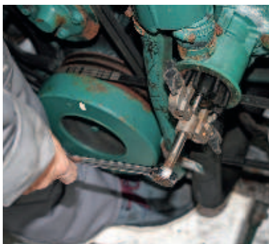
3 Irrota pumpun kansi ja impelleri. Nämä on helpointa irrottaa, kun pumppu on vielä paikallaan.
