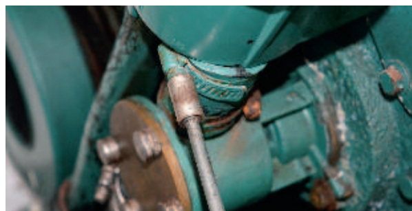
2 Avaa kaksi letkuklemmariä, jotka varmistavat imu- ja työntöletkun liitokset, ja irrota letkut.
