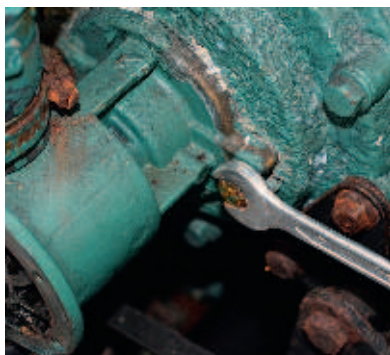
4 Irrota pumpun kiinnitysruuvit ja vedä se irti moottorista.
