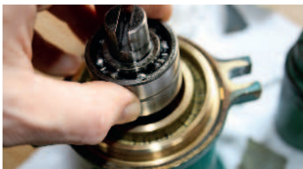
7 Akselin ja laakerit voi koputella ulos kumivasaralla. Jos akseli tulee ulos mutta laakerit eivät, ne täytyy irrottaa ulosvetäjällä.
