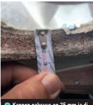
8 Kannen paksuus on 25 mm ja divynycell-väliaine salonin venttiilin aukossa on mustassa homeessa.
