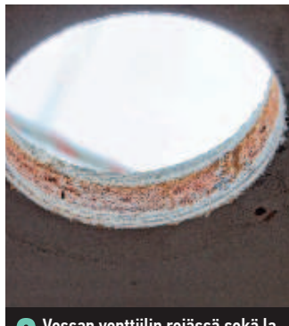
9 Vessan venttiilin reiässä sekä la-minaatti että divynycell olivat paremmassa kunnossa.
