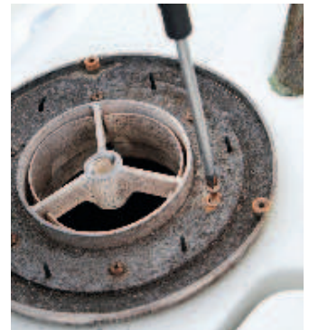
3 Ruuvaa alapuolen levy irti kannesta tai kiinnityspinnasta.
